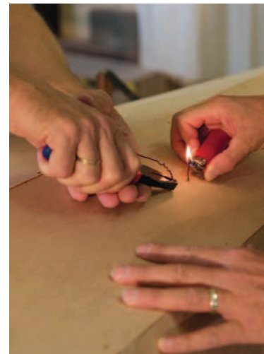
Fast alle Arbeiten können alleine durchgeführt werden, aber zu zweit lässt sich vieles besser handhaben und steigert zudem Spaß- und Motivationsfaktor. Besonders spektakulär: das Entfernen der Überstände des eingenähten Kupferdrahts in den Schottwänden
