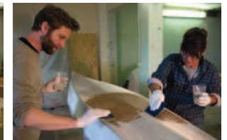
Fast alle Arbeiten können alleine durchgeführt werden, aber zu zweit lässt sich vieles besser handhaben und steigert zudem Spaß- und Motivationsfaktor. Besonders spektakulär: das Entfernen der Überstände des eingenähten Kupferdrahts in den Schottwänden
